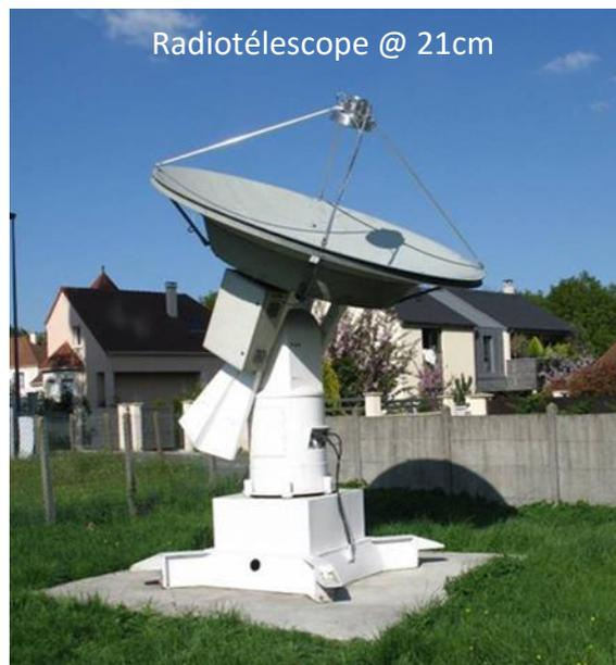
Figure 1 : Antenne 3.3m utilisée pour l'observation des pulsars
