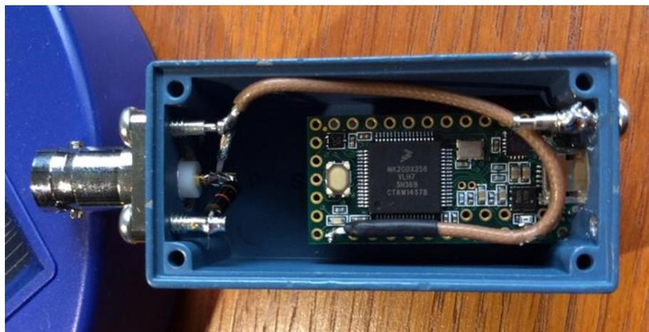
Figure 4 : Module numérisation 16 bits
