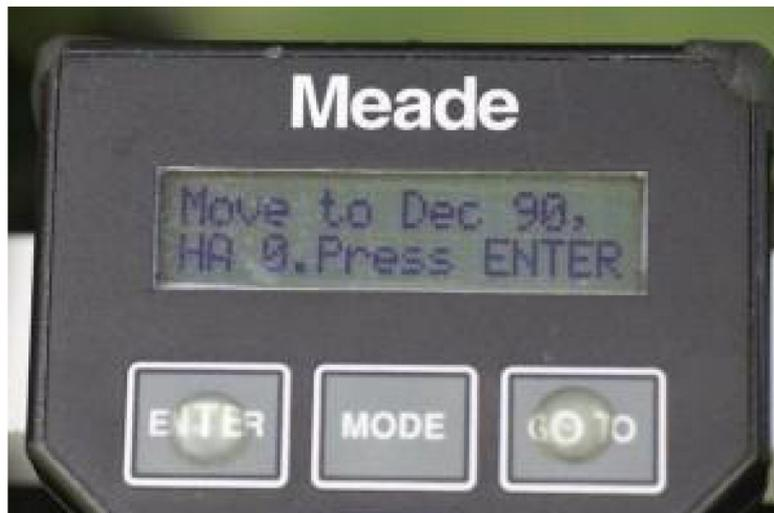
9- Le télescope se place sur l'emplacement prévu pour l'étoile Polaire. Il faut maintenant la centrer le plus précisément possible en utilisant uniquement les mouvements de la table équatoriale, ne surtout pas la centrer en utilisant la raquette !
