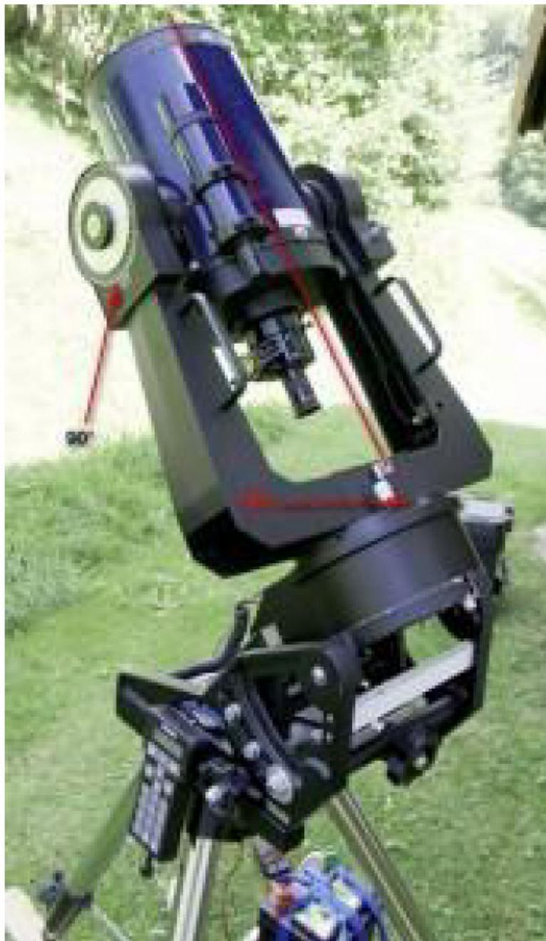
**6- Centrer l'étoile Polaire à l'aide du chercheur uniquement en utilisant les mouvements de la table équatoriale**
