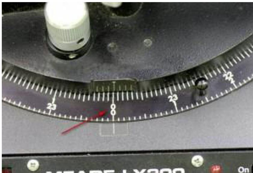
4- Placer approximativement le tube optique dans l'axe polaire (Déclinaison de  $90^\circ$ ).
