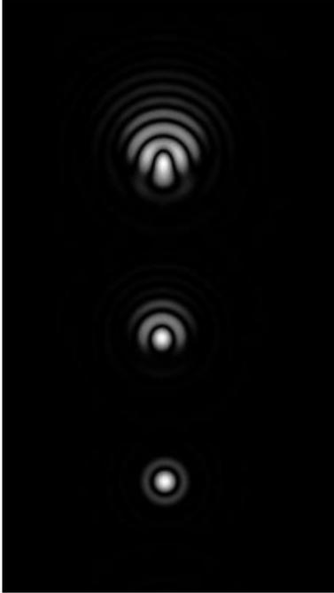
Après quelques essais, on devrait avoir un donut bien symétrique. Il faut donc passer à l'étape suivante. On focalise l'étoile et on examine la tache de diffraction. Cette seconde étape est plus précise, mais nécessite une bonne turbulence. Elle n'est pas toujours réalisable. Dans le doute, s'arrêter là.
