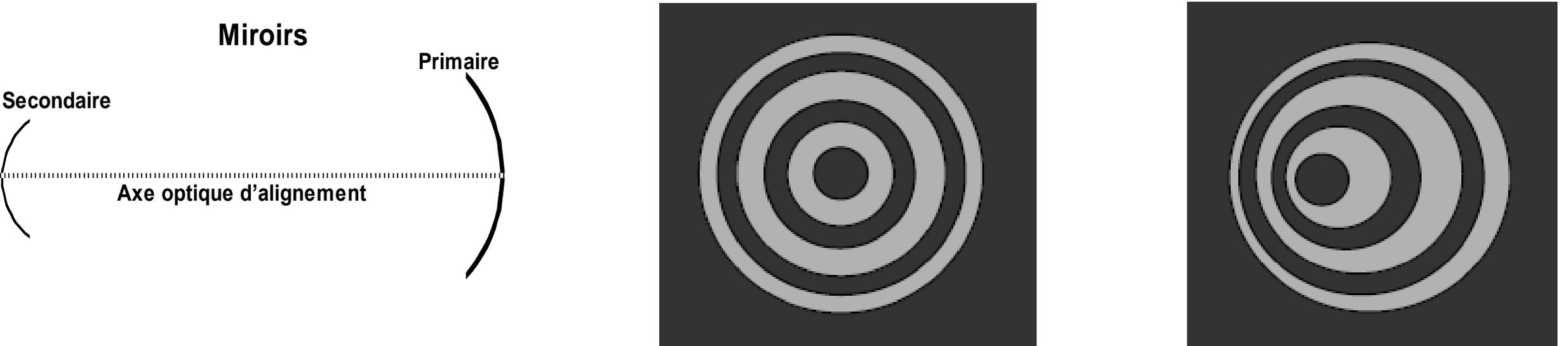
A gauche, schéma du problème de la collimation représenté pour un tube optique avec deux miroirs concaves (type Gregory par exemple).
