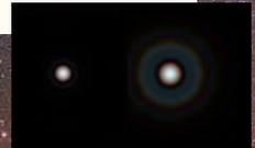
**11.3 La coma :** La figure montre l'image d'une étoile fournie par un télescope de NEWTON en dehors de l'axe optique.
