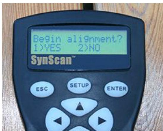
Pour l'initialisation (ou alignement), la monture va pointer une première étoile. Si les réglages initiaux sont bien faits, elle doit partir à peu près dans la bonne direction. Avec la raquette en agissant sur les moteurs d'ascension droite et de déclinaison, on centre alors l'étoile et on valide.
