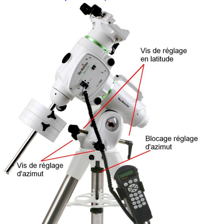
On trouve un premier axe qui permet le réglage d'azimut de la monture (ou de longitude, ou horizontal...).
